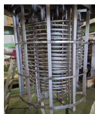
フローリアクターの内部構造。比表面積が広く熱交換効率が高い。また、迅速な混合、精密な反応時間制御が可能。
